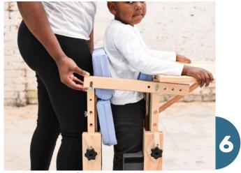
Hook the side supports over the bolts | Hak die kant-plankie oor die skroef en draai dit stewig vas | VALA AMACALA
