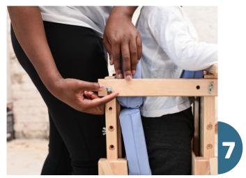
Tighten the wingnuts on both sides | Maak seker die skroewe aan beide kante is styf vasgedraai | QINISA IZIVALO KUMACALA OMABINI
